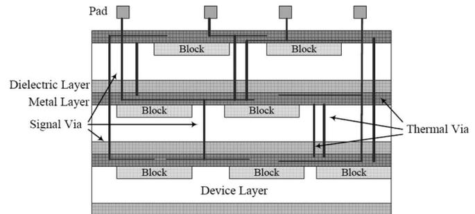
Fig. 1. T-via in 3-D IC stack.
