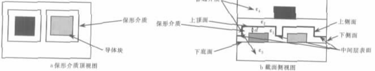
图 5 一个含简单保形结构的三层互连寄生电容器
